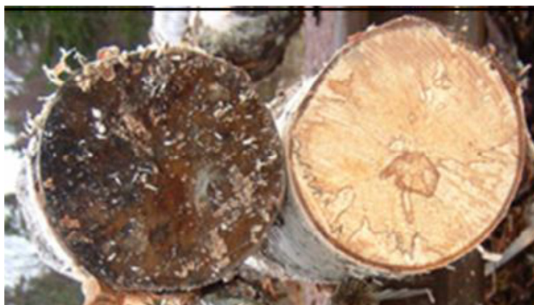
Joonis 4. Laomädaniku esinemine kasepaperipuidu noti otsapinnal ja noti ristlõikel 15 cm kaugusel noti otspinnast
