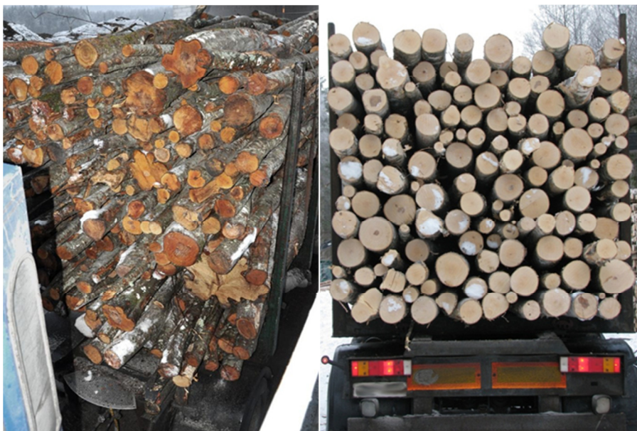
Joonis 14. Näited normaalselt ehk keskmiselt ladustatud lehtpuukütte- ja kasepaberipuidu koormapakkidest. Esineb üksikuid tüükaid, mille põhjuseks on peamiselt nottide puuliigiomane kõverus, mitte viltune ladustamine.
