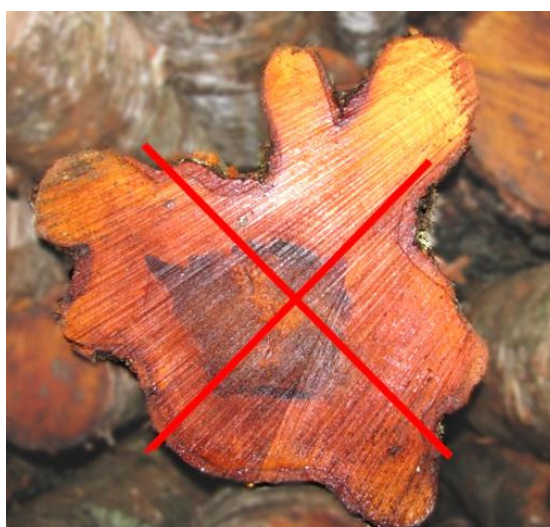
Joonis 8. Suure sagarate sügavusega sagartüüakus kuulub töötlemist (koorimist) takistavate rikete hulka.
