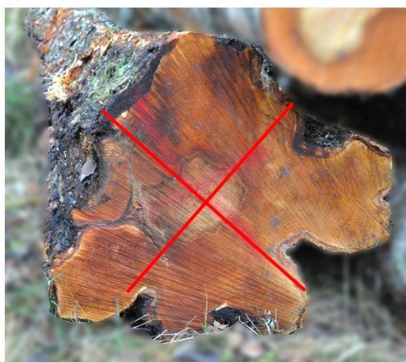
Joonis 8. Suure sagarate sügavusega sagartüüakus kuulub töötlemist (koorimist) takistavate rikete hulka.
